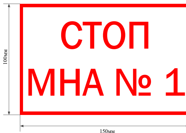
Рисунок 1.2 - Информационная табличка для аварийных кнопок отключения МНА
