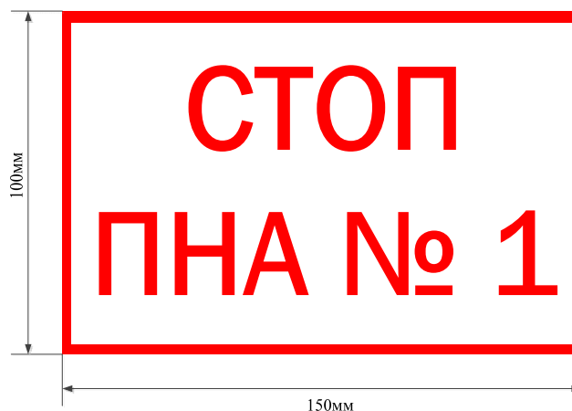
Рисунок 1.1 - Информационная табличка для аварийных кнопок отключения ПНА
